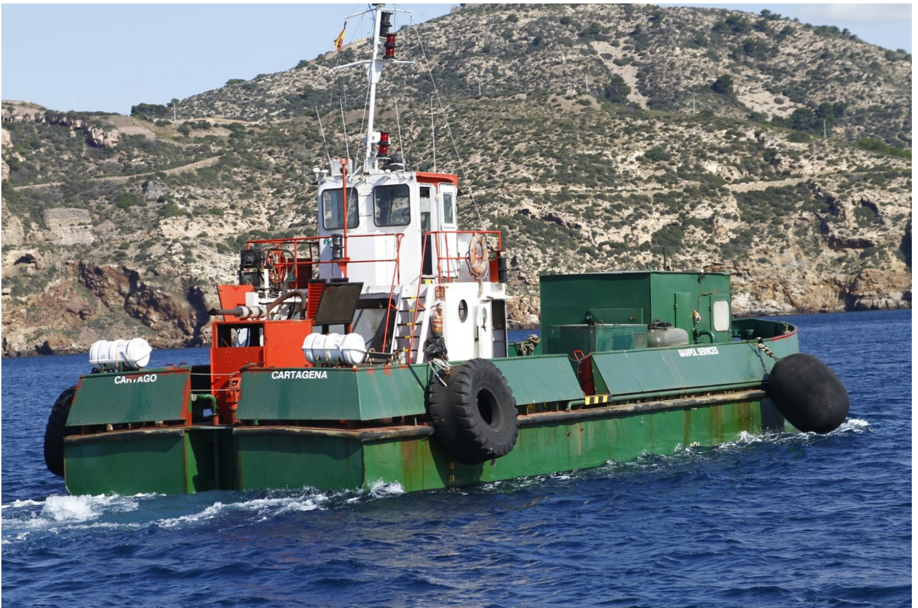
Gabarra Cartago para el servicio MARPOL, cuenta con planta de tratamiento de aguas hidrocarbonadas
