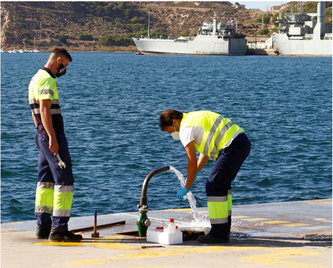
Toma de muestras para el control legionella y calidad del agua potable 2021
