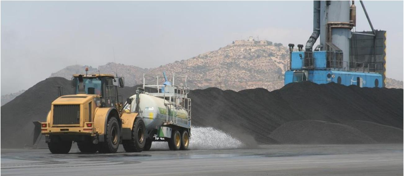
Riego de zona de acopio de coque para reducir la emisión de polvo por tráfico de camiones
