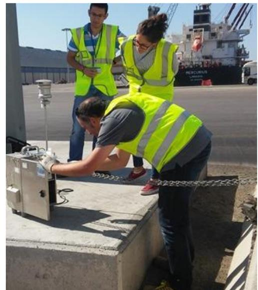
Estudio sobre las partículas de azufre presentes en el polvo de la terminal de graneles de la ampliación de Escombreras, instalación de captadores octubre 2017
