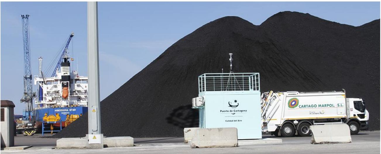
Estación medidora Terminal Polivalente Ampliación de Escombreras, incluye PM10 y PM 2,5
