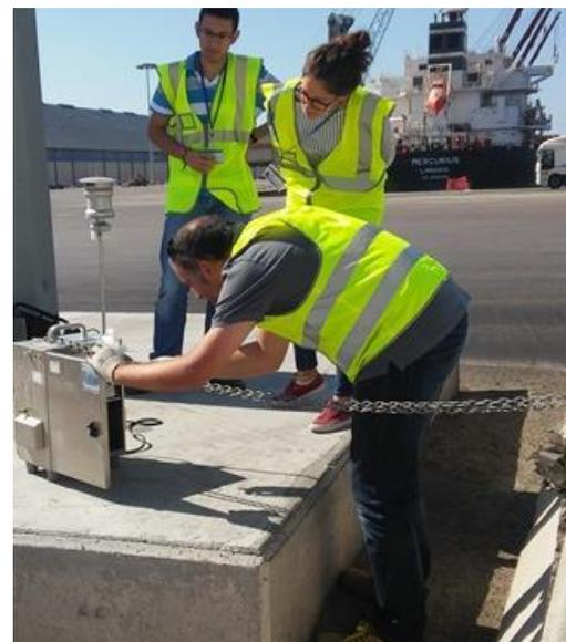
Estudio sobre las partículas de azufre presentes en el polvo de la terminal de graneles de la ampliación de Escombreras, instalación de captadores octubre 2017
