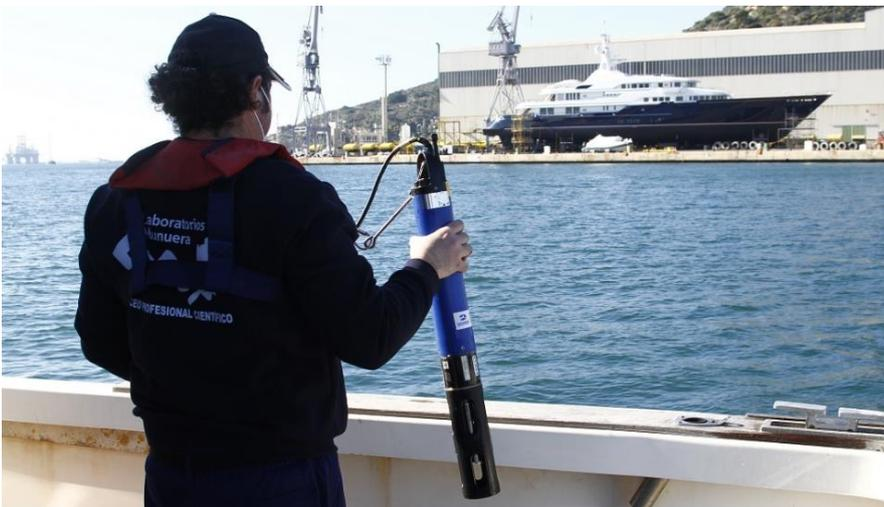
Toma de muestras de sedimentos y sonda multiparamétrica
