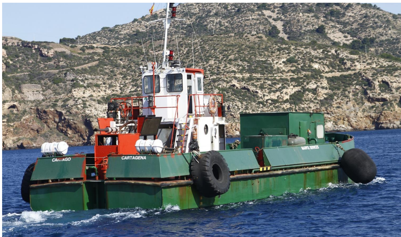
Gabarra Cartago para el servicio MARPOL, cuenta con planta de tratamiento de aguas hidrocarburadas
