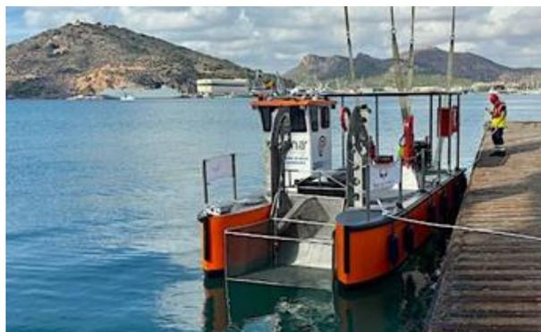
El 24 de octubre de 2024 tuvo lugar el lanzamiento de la embarcación “Solica”, de Cartago Marpol, para la limpieza de aguas portuarias. Con 8.5 metros de eslora y capacidad de carga de 4 toneladas, la embarcación incluye un sistema de recolección de plásticos, una pala de carga, grúa hidráulica, tanques para aguas residuales y placas solares. Además, sus motores de GLP la hacen más eficiente y menos contaminante.
