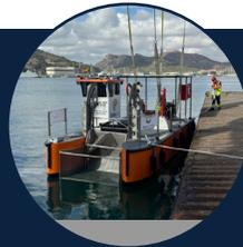
**Embarcación Solica.** Recogida ordinaria de residuos sólidos flotantes, oxigenación de las aguas portuarias iridiscentes y espumosas, toma de muestras y recogida de los residuos que se desprendan de la limpieza a presión de los muelles.
