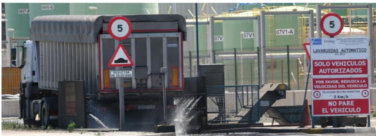
Lavaruedas automático instalado en la terminal de graneles para minimizar las emisiones de polvo procedentes del transporte
